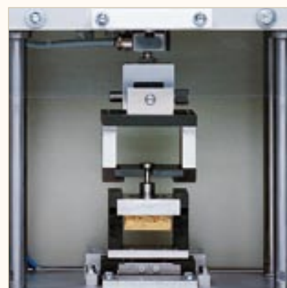
Delamination strength of surface layer (EN 319)
