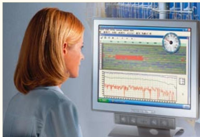
flusst. Diese Prozessparameter stehen wiederum im direkten Zusammenhang mit der Verleimungsgüte einer Platte. Der Reifegrad des Leimes und die Anzahl der Leimbrücken ist ein Maß für die Absorption des Ultraschalls.
