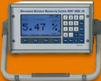
Für die Herstellung von SPAN-, MDF-, HDF- und OSB-Platten ist der Feuchtegehalt der fertigen Platten eine wichtige Qualitätsgröße.
