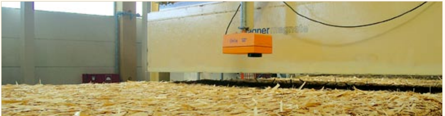
Feuchtemessung hinter der Formstraße
