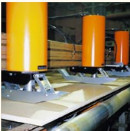
Medición de Espesores DMR 3000
